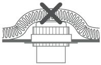
Luminaires qui ne sont pas conçus pour être recouverts avec un matériau isolant thermique.
